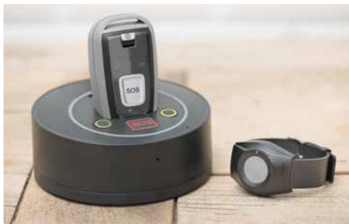
Das moderne Rufhilfe-Gerät kann sowohl als Hausnotruf als auch als mobiler Notruf unterwegs verwendet werden (Bild: LIBIFY Technologies GmbH).
